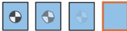
Mesure de la transparence de l'eau à l'aide du disque de Secchi
